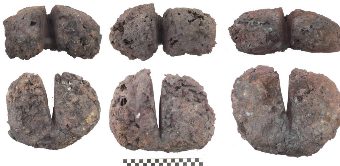
11. ábra: Az #1, #2 és #3 rekonstrukciós kísérletek során készített 9,2, 8,7 és 9,9kg-os ékelt vasbucák sorban felül- és előlnézeten, 20cm-es léptékkel.
