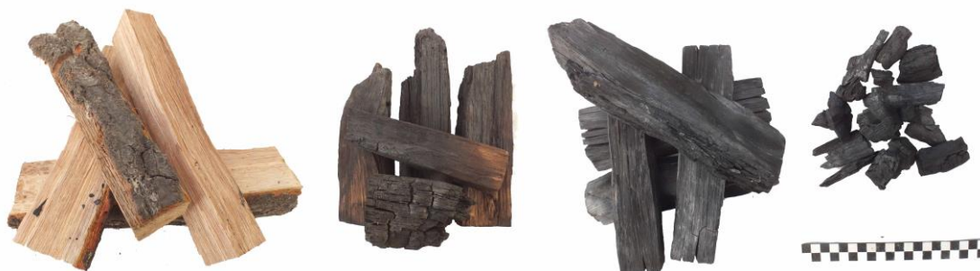
6. ábra: Balról jobbra: a boksákba rakott fahasábok, félíg leszenesedett fahasábok a boksa lábazati részéről, teljesen leszenült fahasábok, a kohósításokhoz 25-50mm-esre tört, frakcionált faszén.
